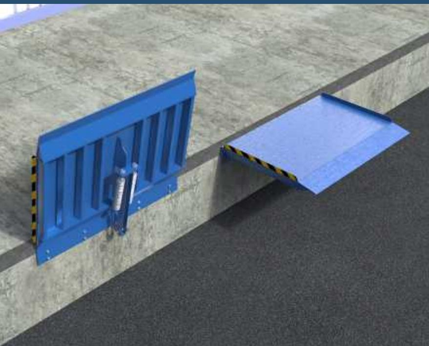
**Откидные мосты** предназначены для разгрузки ж/д вагонов или для разгрузки грузовых автомобилей, когда нет возможности припарковаться вплотную к пандусу. Откидные мосты устанавливаются на открытую рампу в стационарном или скользящем исполнении, компенсируя разницу между пандусом и кузовом грузовой платформы. Грузоподъёмность откидных мостов STL – до 4 тонн.
